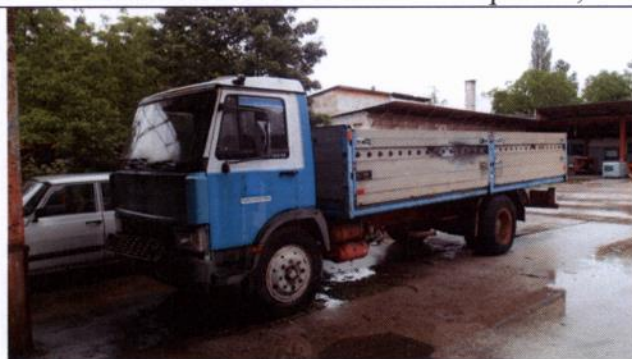
39. Kamion Iveco 109.14.1 – neispravan, derutan , vitalni dijelovi su zahvaćeni korozijom.
