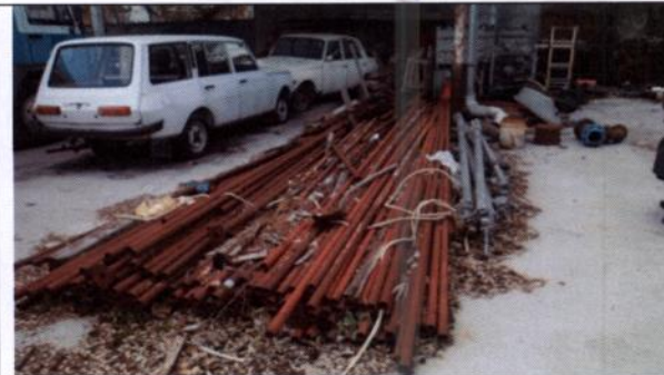
38. Elementi montažne skele Doka – elementi su razbacani desortirani, cijevi su korodirane , ima dosta savijenih i oštećenih.
