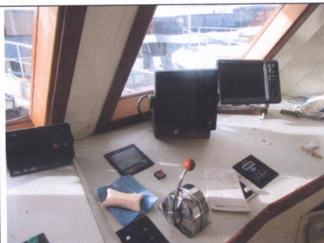
Navigacijska pomagala i upravljanje motorom
