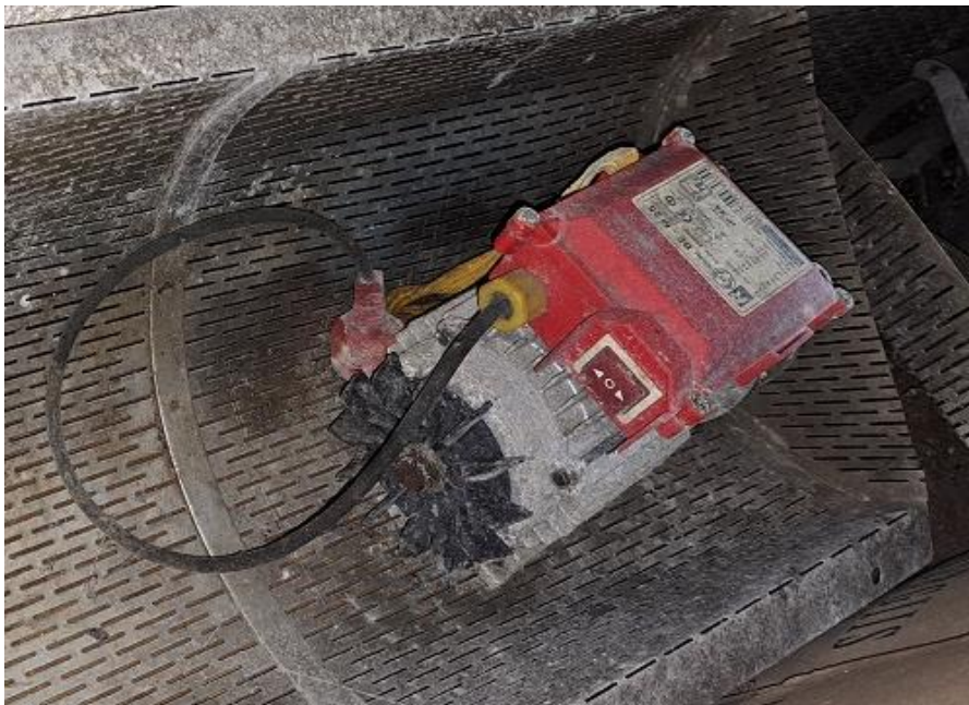
Sl. 25 Pumpa Zambelli T-40 električna , zatečena Rover pump, BE-M25 bez kućišta impelera
