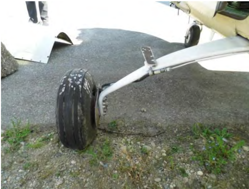
Fotografije 18 do 20 – Izgled sklopa lijevog glavnog kotača podvozja zrakoplova reg. oznake 9A-DER
