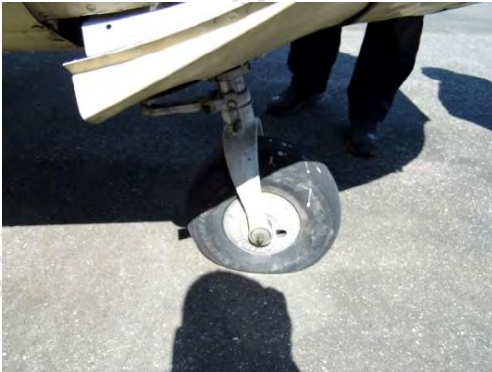
Fotografije 15 do 17 – Izgled sklopa nosne noge podvozja zrakoplova reg. oznake 9A-DER
