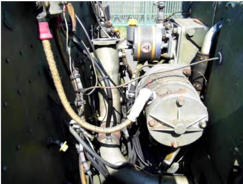
Fotografije 7 do 13 - Izgled klipnog motora Continental IO-520-A, serijskog broja 112907-R ugrađenog na zrakoplov reg. oznake 9A-DER prilikom pregleda stanja zrakoplova dana 28.03.2022.
