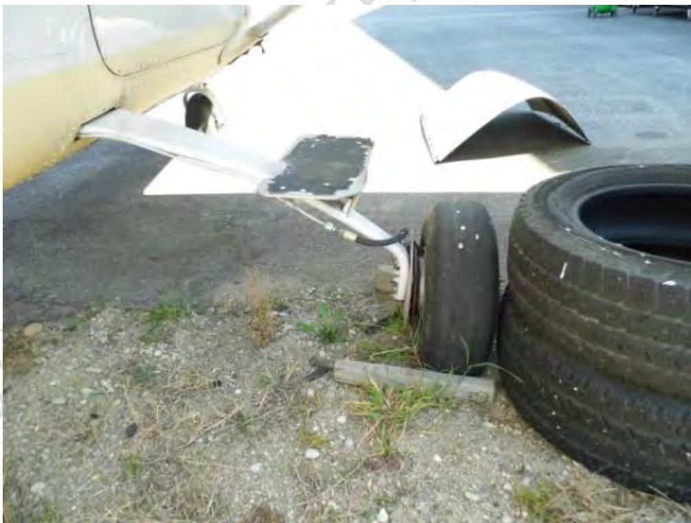
Fotografije 21 do 23 – Izgled sklopa desnog glavnog kotača podvozja zrakoplova reg. oznake 9A-DER
