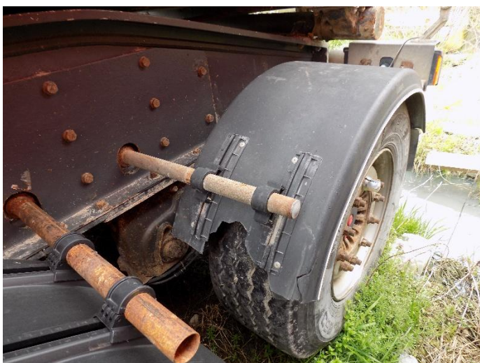
3. CARNEHL – oštećenje blatobrana
