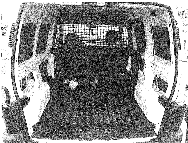
Slika 3. Oštećena podnica tovarnog prostora
