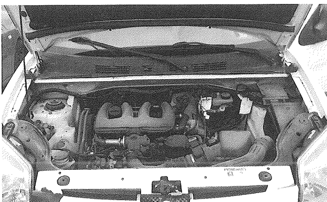
Slika 5. Prikaz motora – nedostaje akumulator
