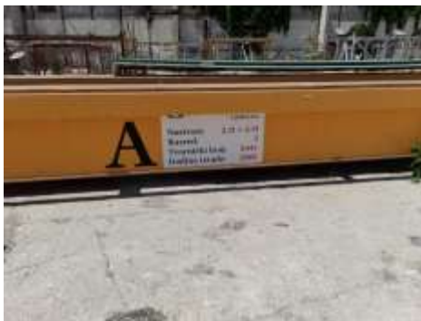
Stavka 1. Dvije mosna dizalica sa po dva vitla sa kranskom stazom i nosačima staze
