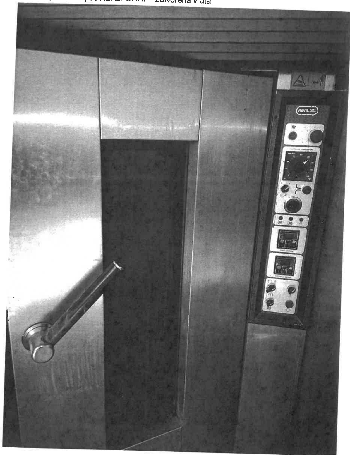
2.1. Roto pekarska peč REALFORNI – zatvorena vrata
