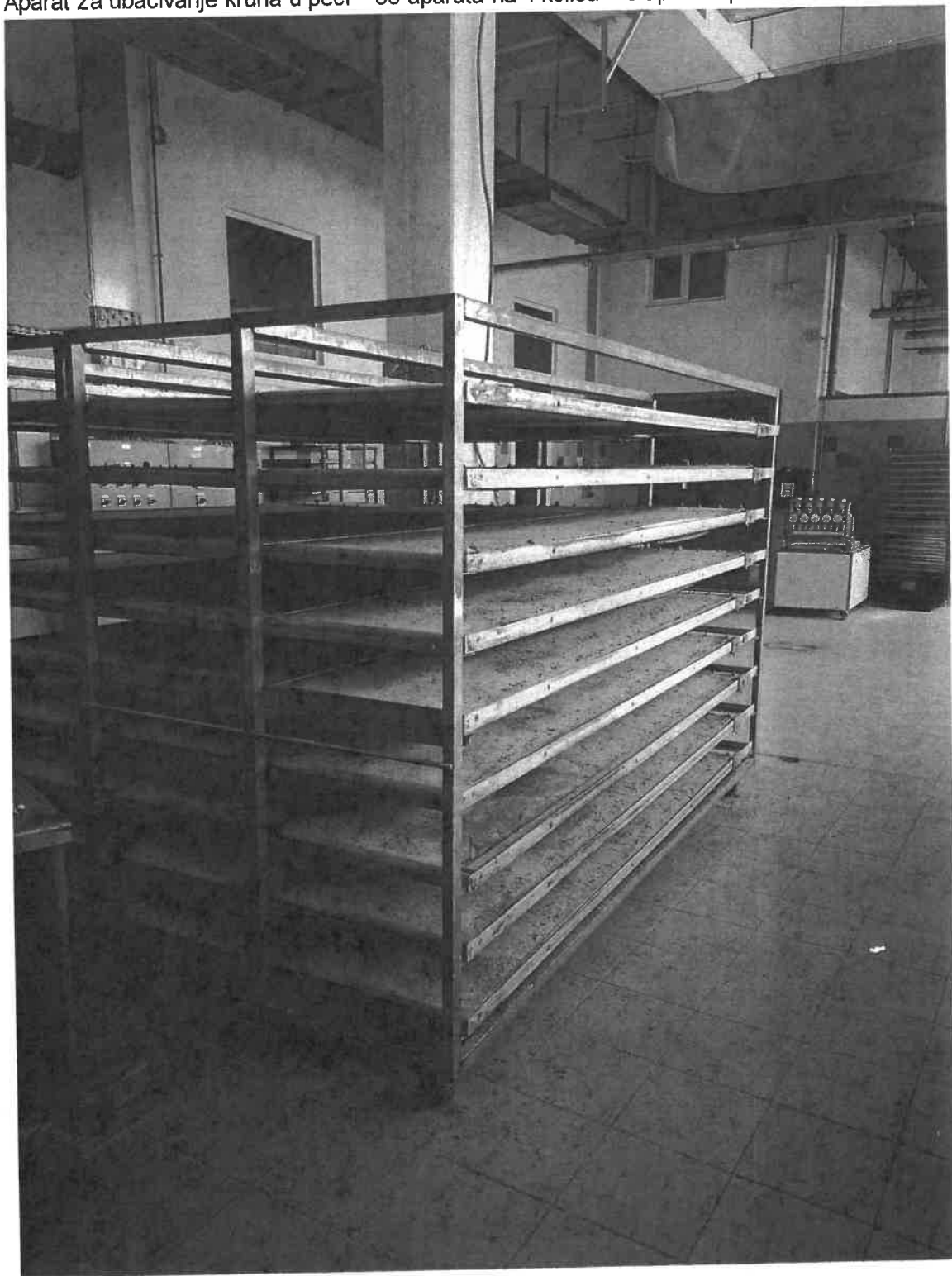
16. Aparat za ubacivanje kruha u peći – 36 aparata na 4 kolica – 9 aparata po 1 kolicima
