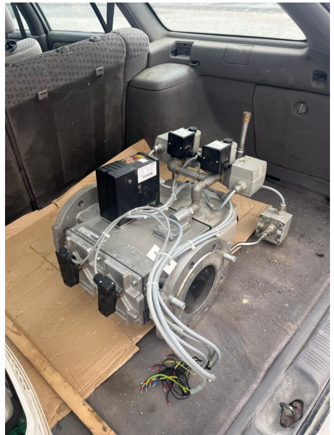
Fotografija 26. Demontiran plinski ventil DUNGS (u trenutku fotografiranja nalazio se u prtljažniku automobila protustranke)
