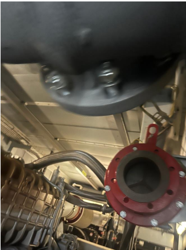
Fotografija 25. mjesto na jednom plinskom motoru s kojeg je demontiran plinski ventil DUNGS
