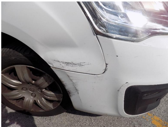
8. Peugeot Partner – oštećenje branika I blatobrana
