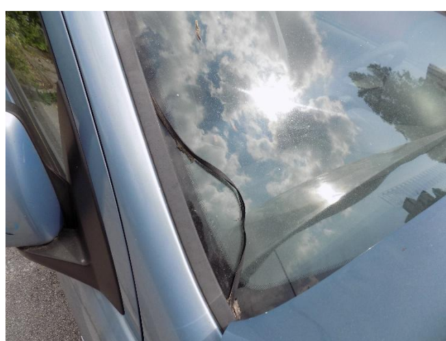
12. Opel Combo – oštećenje gume na vjetr, staklu
