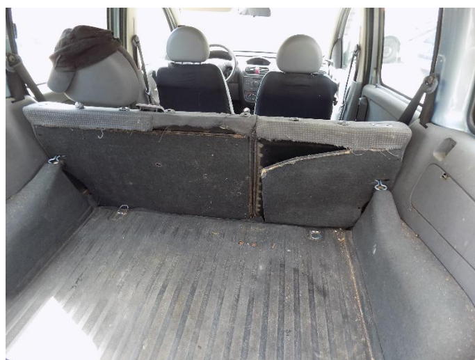
10. Opel Combo – oštećenje sjedala
