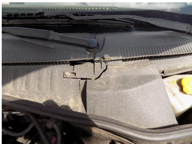
11. Opel Combo – oštećenje plastike
