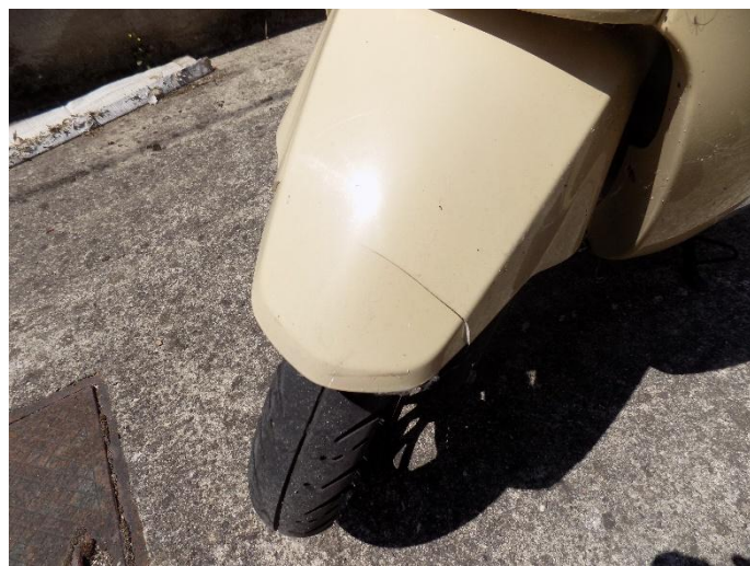
4. SKUTER EFUN – oštećenje blatobrana
