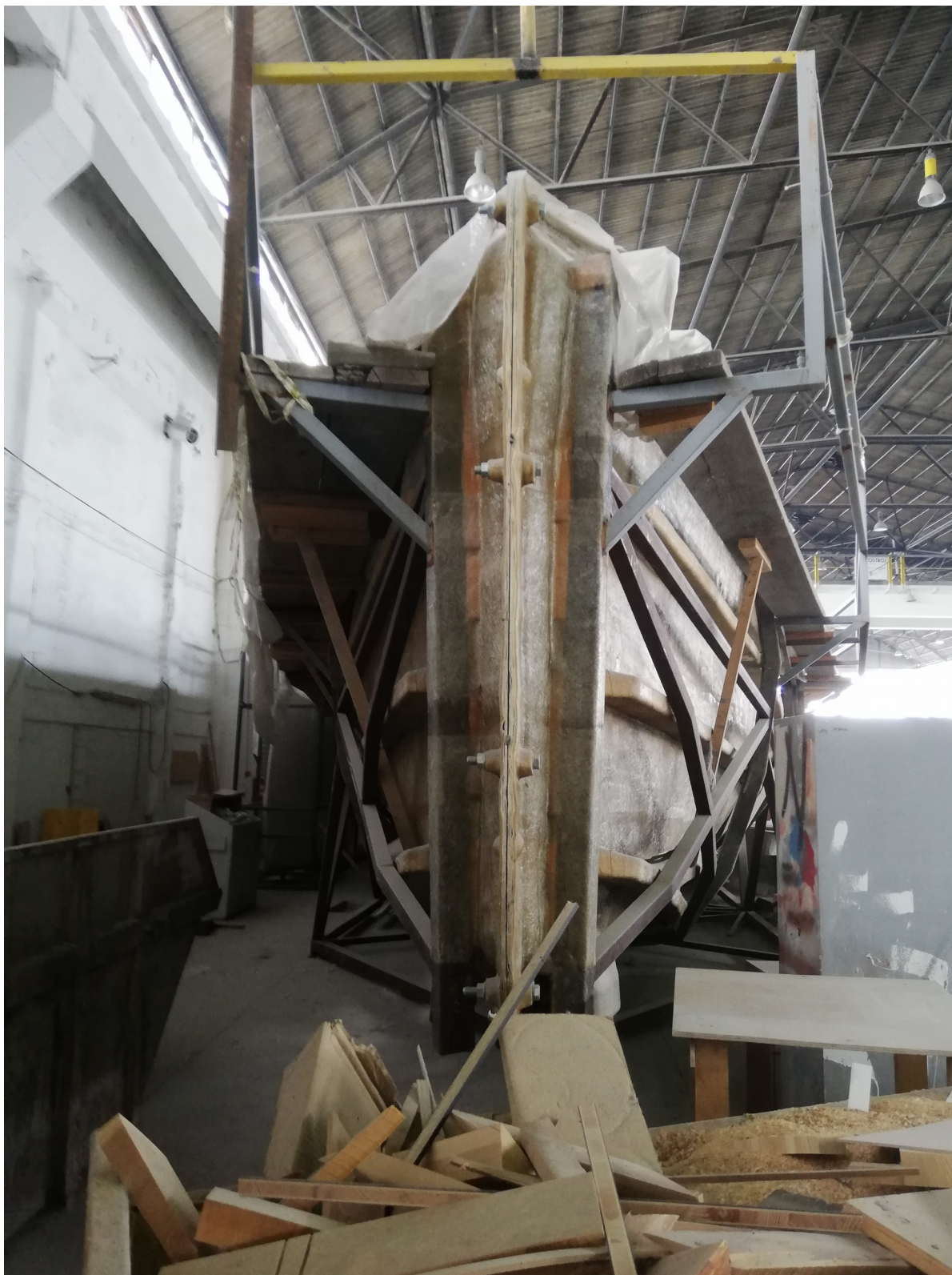
sl.8 pramčani spoj lijeve i desne polovice kalupa
